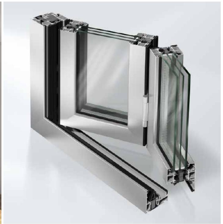
Уникальная складная раздвижная дверь, позволяющая удовлетворить актуальные требования по теплоизоляции, подкупает также малой шириной видимой части и большим разнообразием типов. Складная раздвижная система Schüco ASS 80 FD.HI обеспечивает также повышенную теплоизоляцию (коэффициенты  $U_f$  до  $1,7 \text{ Вт}/(\text{м}^2\text{К})$  и  $U_w < 1,3 \text{ Вт}/(\text{м}^2\text{К})$ ) и большое разнообразие вариантов дизайна.
